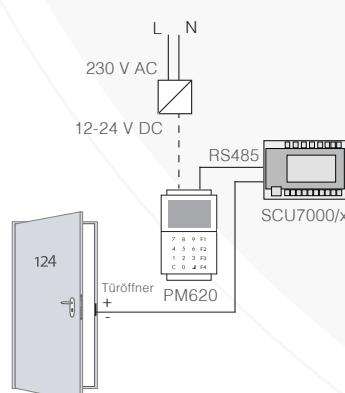
**Hinweis:** Eine ext. Spannungsversorgung wird nur bei Anschluss an eine SCU7000/32 benötigt. In diesem Fall wird der Türöffner an das PM620 angeschlossen.
