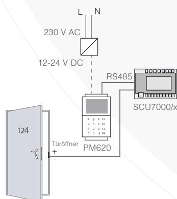
**Hinweis:** Eine ext. Spannungsversorgung wird nur bei Anschluss an eine SCU7000/32 benötigt. In diesem Fall wird der Türöffner an das PM620 angeschlossen.
